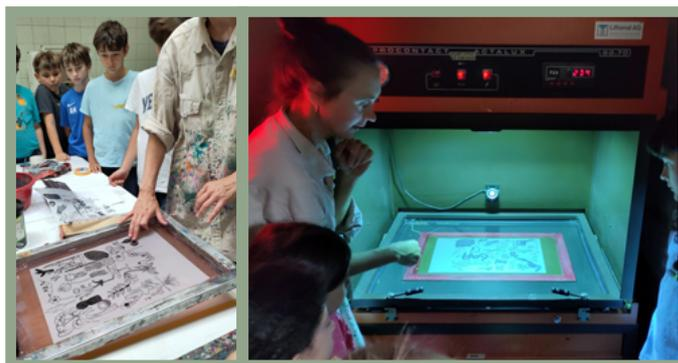
um die nicht belichteten Teile der Emulsion zu entfernen. Dies hinterliess die Druckflächen, durch die die Farbe gedrückt werden konnte.
