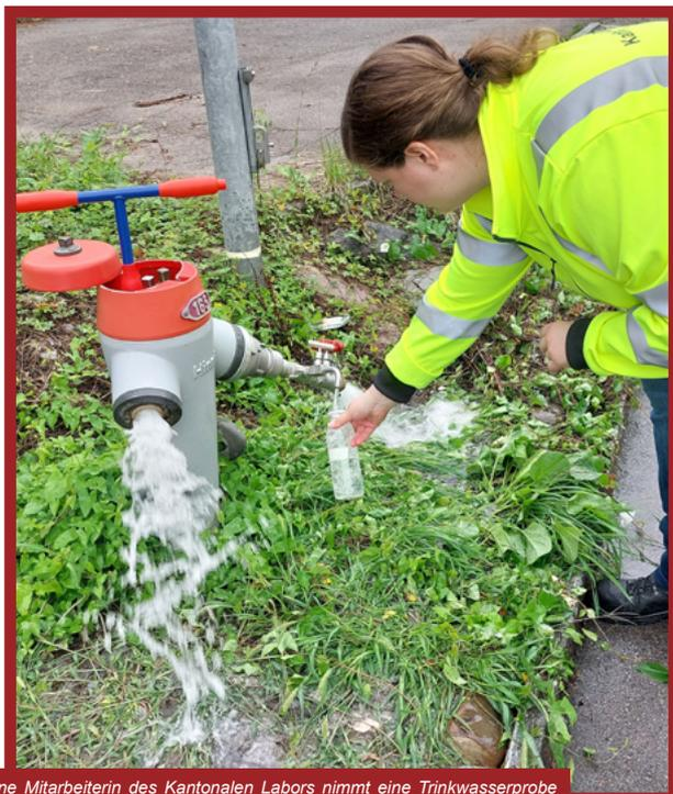
Eine Mitarbeiterin des Kantonalen Labors nimmt eine Trinkwasserprobe an einem Hydranten.
