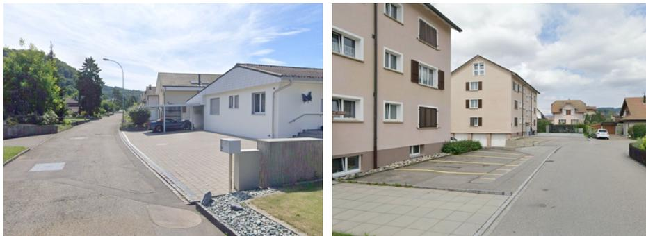
Abbildung 7: der gesamte Vorbereich ist optisch versiegelt. Auch wenn das Wasser teilweise versickern kann (technisch möglich) entsteht der Eindruck einer vollständig geschlossenen Fläche. Auch in Bezug auf die Erwärmung ist diese Lösung zu vermeiden.
